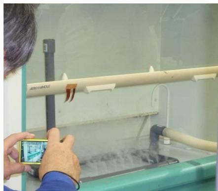
図2 局所排気装置内の気流観察
